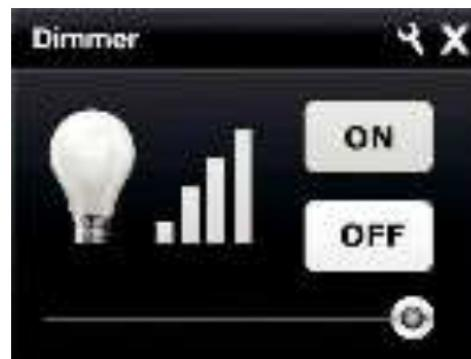
Plynul  stmvani/zvy ovani jasu se ovlada pomocí posuvníku. Zobrazuje se i aktuální stav jasu svítidla. Pro upln  zapnuti/vypnuti jsou k dispozici ikony ON a OFF.
