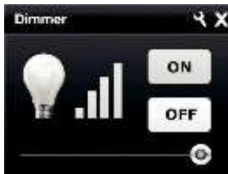
PlynulÄ stmivání/zvÄjování jsou se ovládá pomocí posuvníku. Zobrazuje se i aktuální stav jasů svítidla. Pro uplnÄ zapnutí/vypnutí jsou k dispozici ikony ON a OFF.
